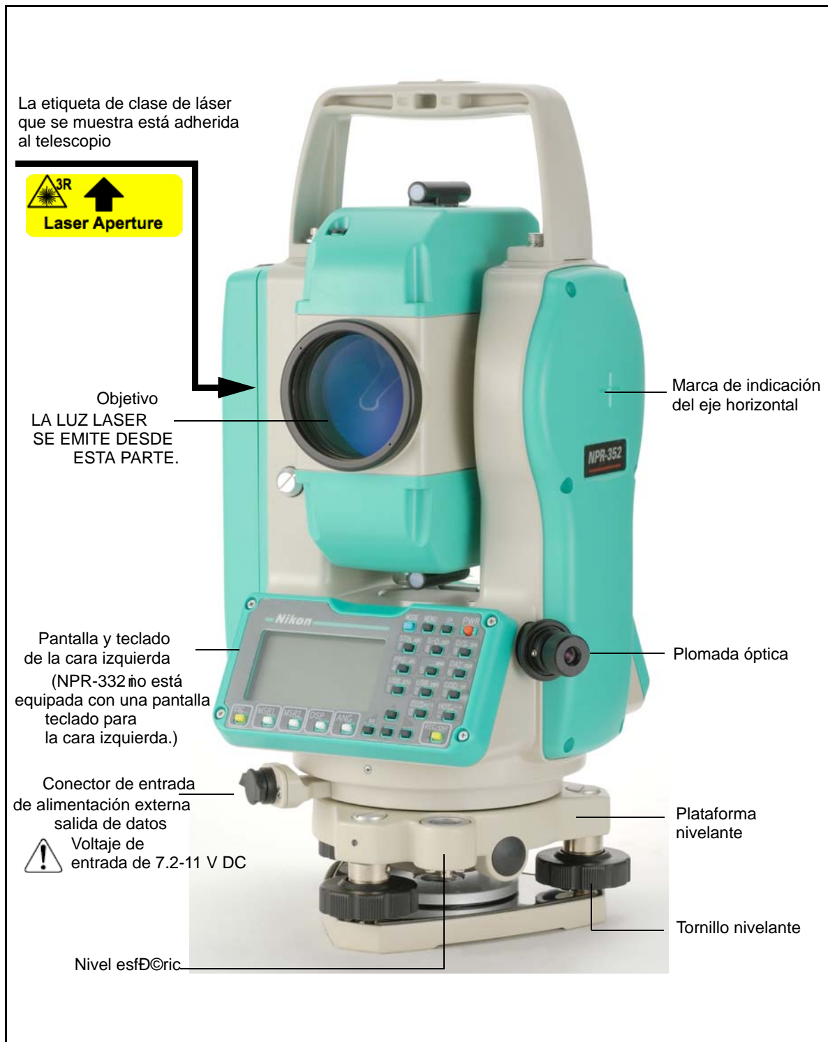
Figura 1.2 Estaciones totales de la serie NPR-302 series – Cara izquierda
