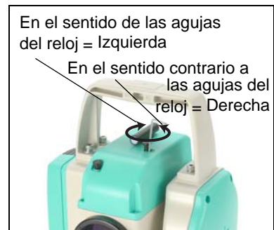
Ajuste de la posición horizontal
