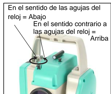
Ajuste de la posición vertical
