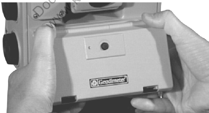
Figura 12.1 Conexión de la memoria de tarjeta a un instrumento
